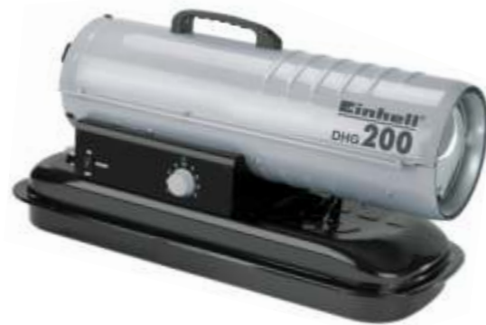
Diesel generator vročega zraka 20kW Gorivo: diesel, rezervoar 19 l, pretok zraka 400 m 3 /h, poraba 2,0 l/h, napetost 230 V, 50 Hz, 1,5 A 299,90 EUR
